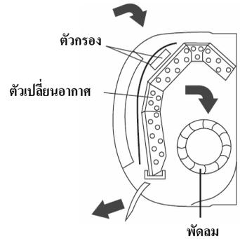
เมื่อขั้นตอนการทำความเย็นเสร็จสิ้น พัดลมจะส่งอากาศบริสุทธิ์เข้าสู่ภายในห้อง ทิศทางของช่องส่งอากาศออกมาจะได้รับการกำหนดโดยแผ่นพัด ซึ่งจะมียอเตอร์ขึ้นและลงและสามารถปรับตัวกั้นทิศทางการเป่าลมซ้ายและขวาได้โดยผู้ใช้งาน
